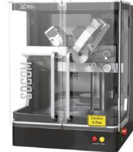
コンパクトで、高性能の結晶方位測定が可能。測定時間はわずか 10 秒。
